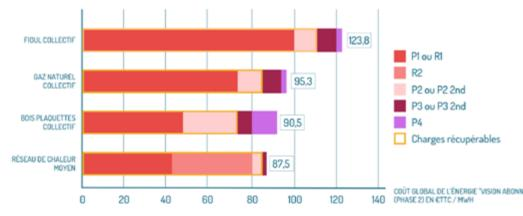
P1: Coût de la fourniture d'énergie / R1: Part variable du coût de la chaleur au kWh pour l'abonné / R2: Part fixe du coût de la chaleur au kWh souscri pour l'abonné / P2: Coût de maintenance courante / P2 2nd : Coût de maintenance courante du réseau secondaire / P3: Coût de renouvellement du matériel / P3 2nd : Coût de renouvellement du matériel pour le réseau secondaire / P4: Coût dinvestissement dans le système de chauffage
